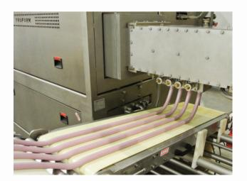
**Implantation réduite au minimum :** un Intrudeur remplace les équipements traditionnels tels que le tambour de refroidissement, l'étireuse ou le malaxeur bras en Z, ainsi que la manutention et la découpe afin d'alimenter les équipements de mise en forme.
